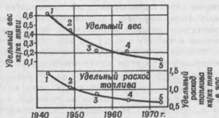
Рис. 1. Изменение удельного веса и удельного расхода топлива турбореактивных двигателей боевых самолетов: 1 — ТРД УМО.004; 2 — ТРДФ J47 — GE.17; 3 — ТРДФ J79 — GE.3A; 4 — ТРДДФ TF30 — P1; 5 — ТРДДФ F100-PW-100.
