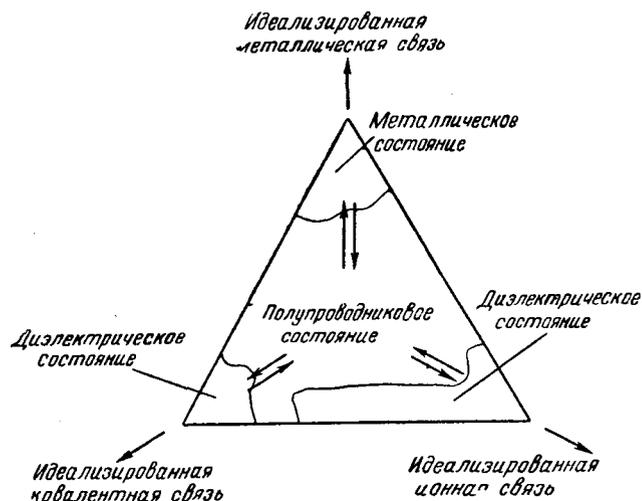
Рис. 2. Электрические состояния, наблюдаемые в неорганических соединениях в зависимости от характера химических связей.
