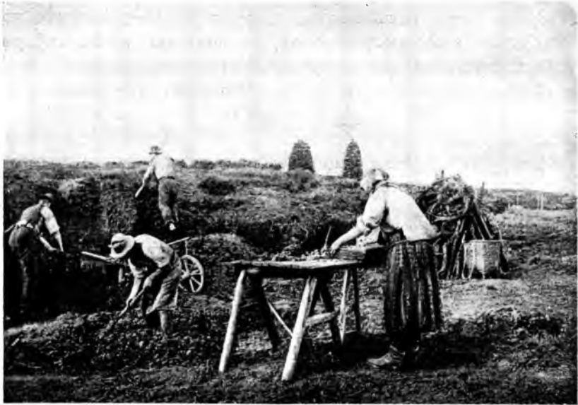
Рис. 12. Приготовленіе рамочно-формованнаго торфа.
