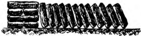
Рис. 21. Укладка плитокъ на торець.
