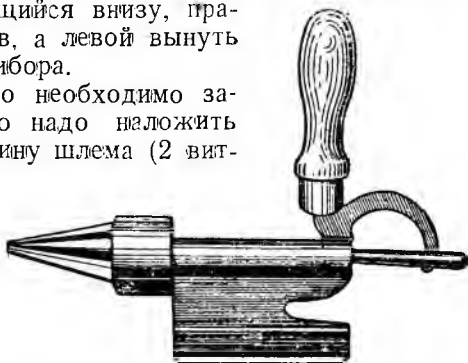
Рис. 29. Прибор для надевания шлема (для взрослых) на патрубок.
