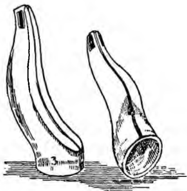
Рис. 8. Однотрубчатый обтекатель маски Мод. О-8.
