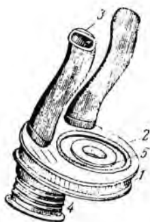
Рис. 12. Клапанно-распределительная коробка маски О-11 и шлема-маски ШМ-1:
