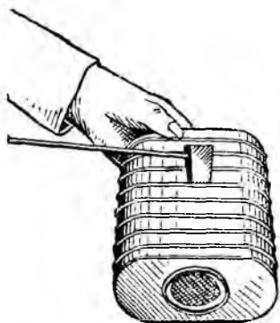
Рис. 33. Запайка прокола на корпусе противогазовой коробки.
