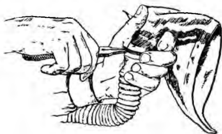
Рис. 31. Закрепление гофрированной трубки проволокой на патрубке с помощью плоскогубцев.
