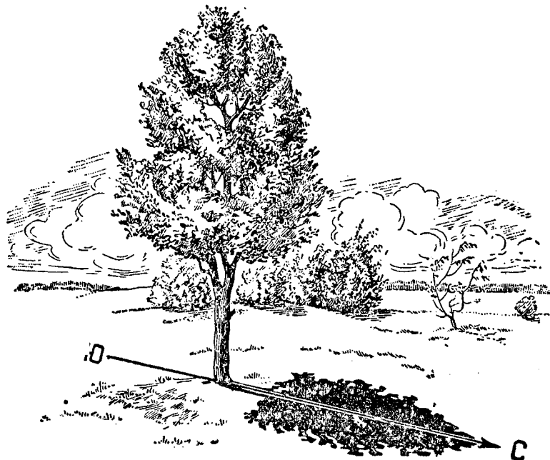
Рис. 22. Определение сторон горизонта по солнцу и тени, падающей от дерева в 12 часов
