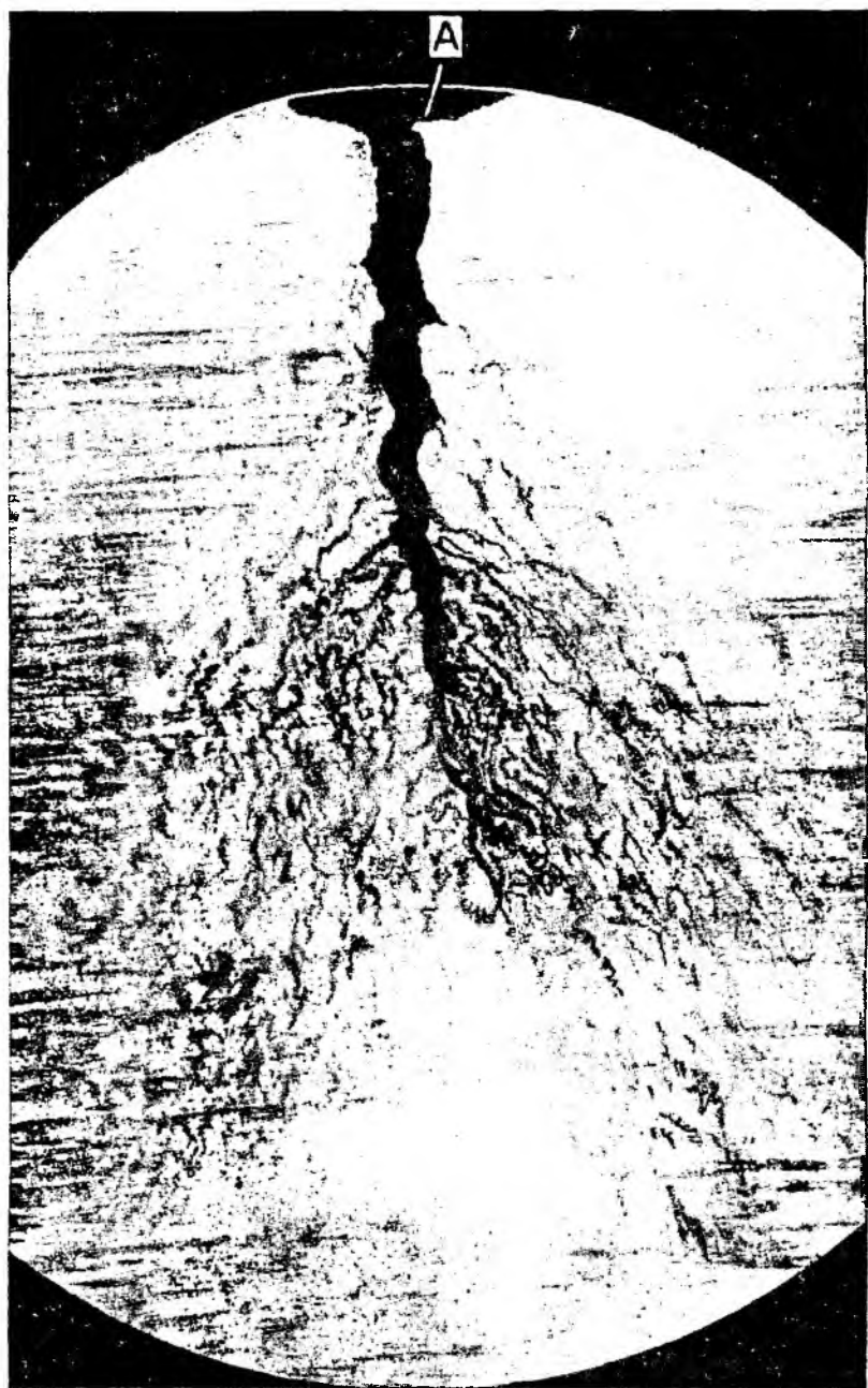
Фиг. 77. Трещина усталости на листе котельного железа (не травлено). Начало трещины у отверстия А. \times 35
