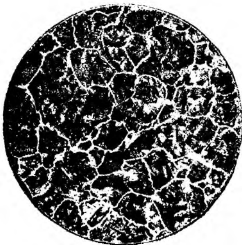
Фиг. 48. Заэвтектоидная сталь. Цементит (белые) и перлит. Цементитовая сетка обрисовывает первичные аустенитовые зерна
