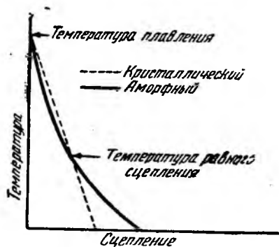
Фиг. 17. Изменение сил сцепления в зависимости от температуры
