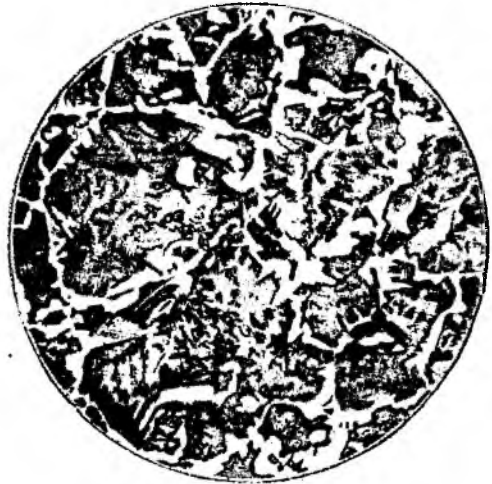
Фиг. 46. Довзвектоидная сталь, содержащая около 0,40% С. Данная микрофотография указывает на присутствие феррита (белые) и перлита (темные); \times 100
