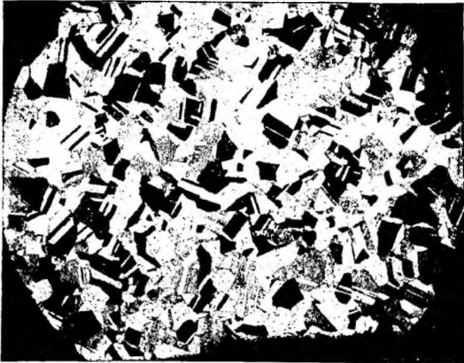
Фиг. 38. Микрофотография \alpha -латуни, 65% Cu и 35% Zn
