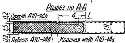
Рис. 91. Дет. А10-14. Прокладка всасывающего выхлопного коллектора
