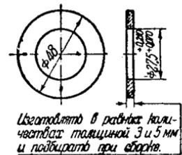
Рис. 177. Дет. № 0811. Шайба упорная шестерни водяного насоса
