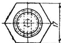
Рис. 129. Дет. № 16-04. Корпус топливного клапана карбюратора
