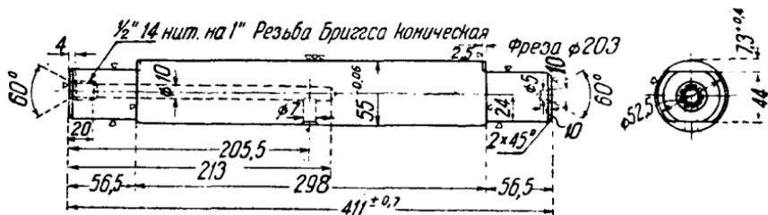
Рис. 592. Дет. 2132. Ось нижних роликов
