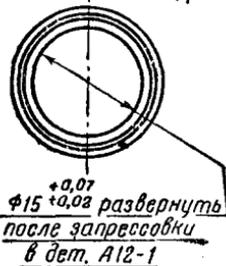
Рис. 95. Дет. № А12-11. Втулка водяного насоса, передняя
