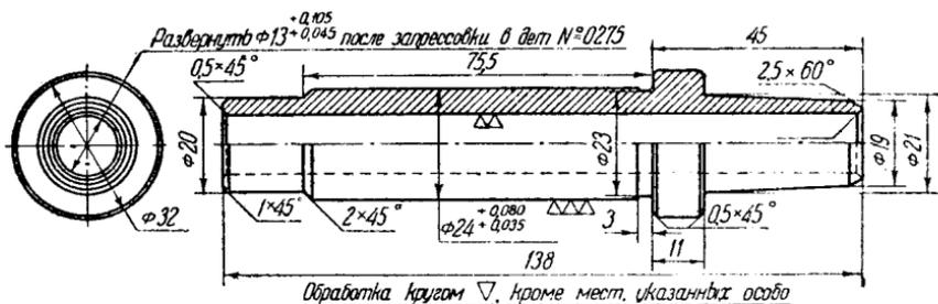
Рис. 247. Дет. № 0278. Втулка клапана направляющая
