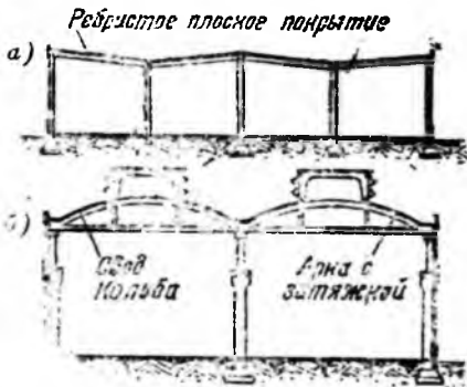
Рис. 172. Балочные и арочные железобетонные конструкции
