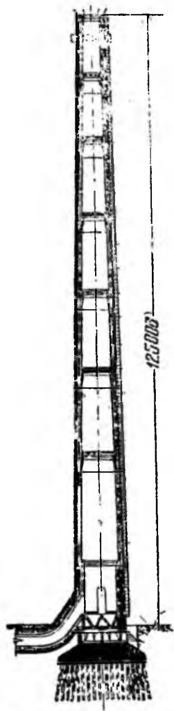
Рис. 399. Железобетонная дымовая труба
