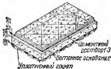
Рис. 149. Пол из бетонных плиток
