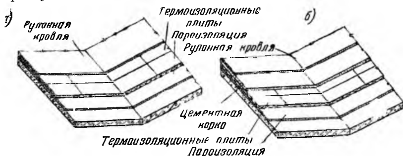
Рис. 155. Утепление покрытий
