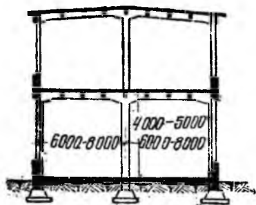
Рис. 339. Многоэтажное двухпролетное производственное здание
