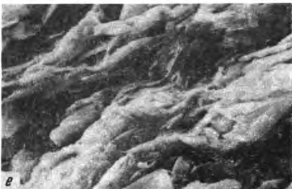
перпендикулярных трещин, X 3; д, е – параллельная взаимная ориентация глинистых частиц (ламинарный тип микростроения) в глинистых микрослоях, РЭМ, X 2000 ( д ), X 4000 ( е ); ж – микростроение переходных слоев (глинистые агрегаты огибают пылеватые частицы), РЭМ, X 4000; з – микростроение пылеватых слоев, РЭМ, X 4000
