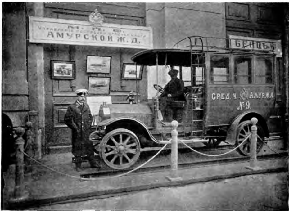
Автомобиль на рельсахъ, работавшій при постройкѣ Амурской желѣзной дороги.
