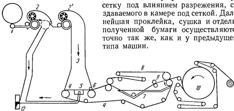
Рис. 225. Бумагоделательная машина с одним расчесывающим и расчесывающе-диспергирующим узлом:
