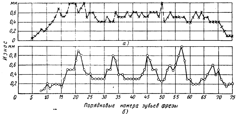
Рис. 5. Характер износа зубьев фрезы при обработке эвольвентных шлицев с величиной перемещения, равной:
