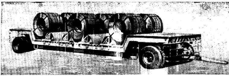
Рис. 5. Прицеп TLF 6013 для перевозки рулонной стали грузоподъемностью 60 т фирмы Хи-но (Япония)
