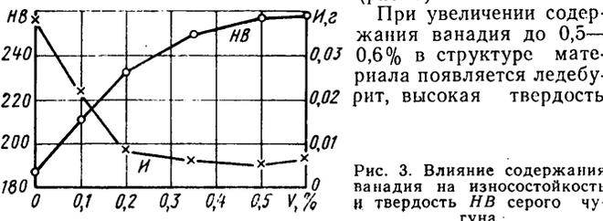
Рис. 3. Влияние содержания ванадия на износостойкость и твердость НВ серого чугуна
