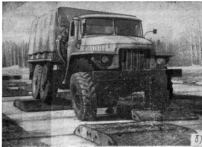
Рис. 3. Деформированное состояние ходовой части автомобиля на специальных для форсированных испытаний дорогах: а — ухабистой комплексной испытательной трассы (КИТ); б — треке ЦНИАП НАМИ
