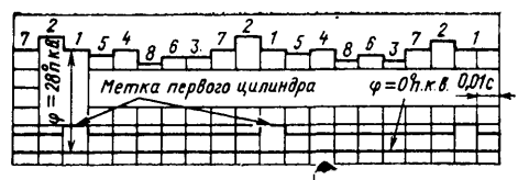
Рис. 2. Осциллограмма изменений угла опережения зажигания в цилиндрах двигателя V-8, работающего на установившихся режимах (1, 2... — номера цилиндров)
