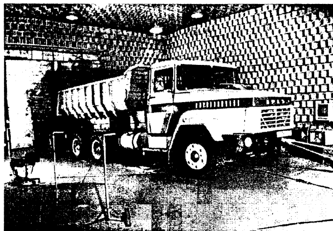
Рис. 2. Акустические испытания автомобиля в большой полузаглушенной камере
