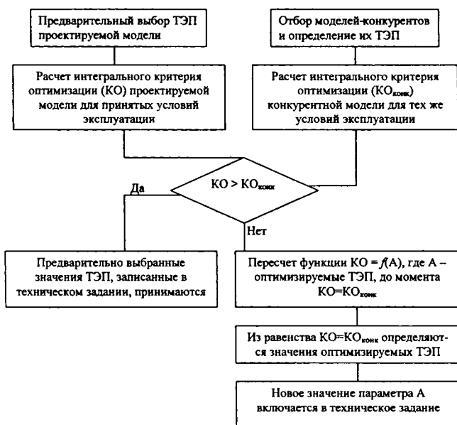
Рис. 1. Алгоритм оптимизации автомобиля по интегральному технико-экономическому критерию
