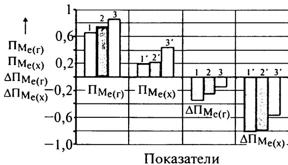
Рис. 3. Изменение средних (за одинаковое время работы t_{пр} , т. е. время разгона от 100 \text{ мин}^{-1} плюс некоторое время работы при конечном скоростном режиме) относительных показателей качества НУР ( \Pi_{Me} ), а также изменения их относительных отклонений за переходные процессы разгонов горячего или холодного дизеля:
