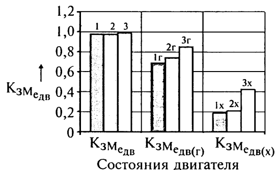
Рис. 4. Зависимость коэффициента загрузки дизеля по моменту при реализации разгона двигателя в диапазоне частот 100-2200 \text{ мин}^{-1} от его состояния:
