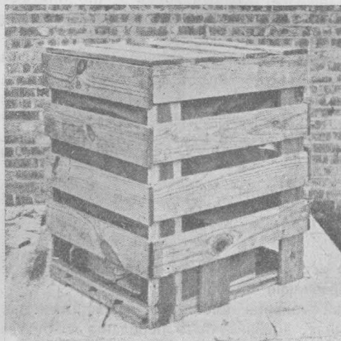
Рис. 1 и 2. Рациональная упаковка грузов: экономит материал (дерево), легкая по весу, что особенно важно при пересылке по ж. д. Для первого ящика требуется всего 50 футов досок, а для второго еще меньше—только 39 футов. Во втором ящике обратите внимание на углы (прочно сшитые) и на диагональные скрепы. Вторая упаковка прочнее, дешевле и легче первой.
