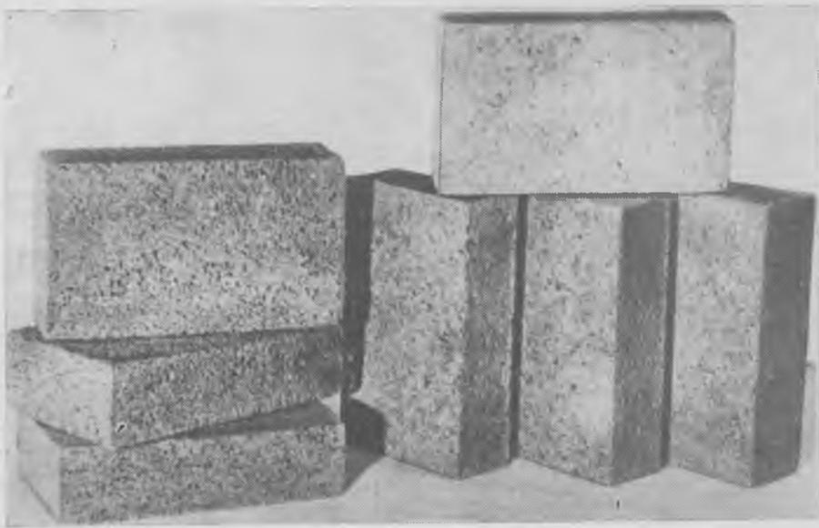
Рис. 2. Блоки из ячеистого фосфатного жаростойкого бетона ( $\gamma=600 \text{ кг/м}^3$ ) для изоляции стекловаренных печей
