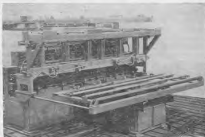
Рис. 2. Сварочная машина МТМ-32У4 для сварки унифицированных сеток
