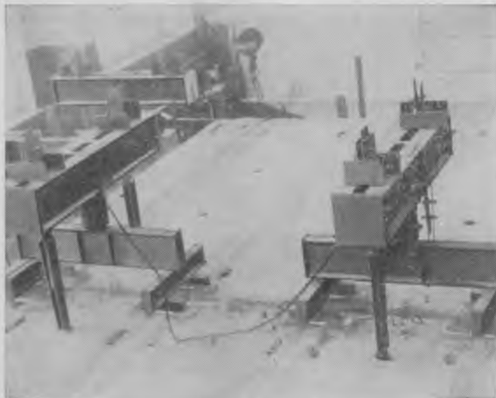
Рис. 1. Испытание фрагмента перекрытия полосовой нагрузкой
