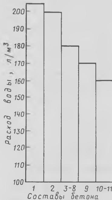
Рис. 1. Водопоглощение бетонной смеси с различными добавками при О. К.=7 см
