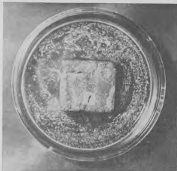
Рис. 2. Цементный кубик в возрасте 1 года в среде золотистого стафилококка. Зона задержки роста культуры бактерий отсутствует
