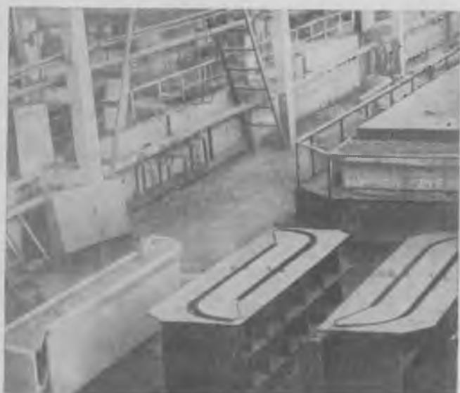
Рис. 2. Кассетная форма-установка для изготовления экранов лоджий
