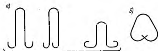
Рис. 1. Монтажные петли а — традиционной формы; б — замкнутого контура
