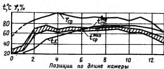
Рис. 2. Производственные испытания по стабилизации температурно-влажностных условий твердения бетона в камерах непрерывного действия
