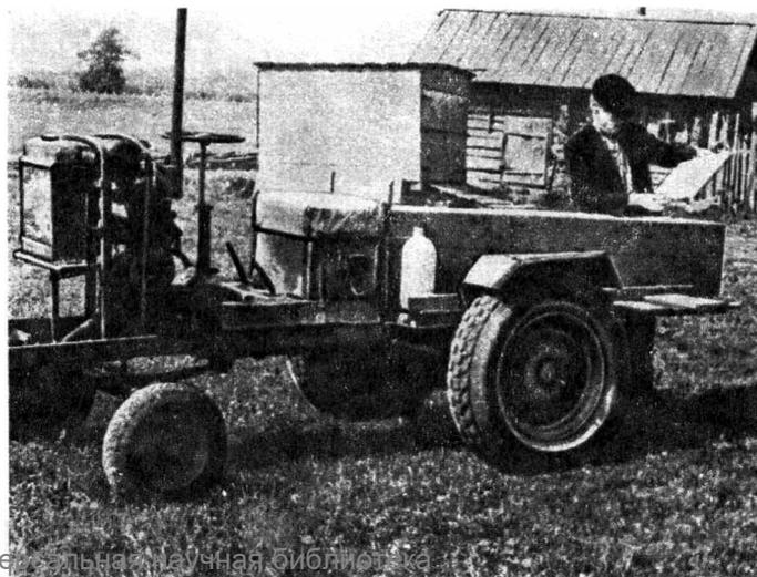
Самодельное шасси для перевозки пасечных грузов.
