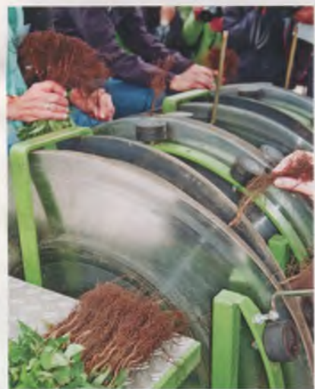
Машина, позволяющая высаживать по несколько тысяч растений в день. Очень важно правильно заправить саженцы в механизм.
