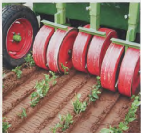
Машина, позволяющая высаживать по несколько тысяч растений в день. Очень важно правильно заправить саженцы в механизм.
