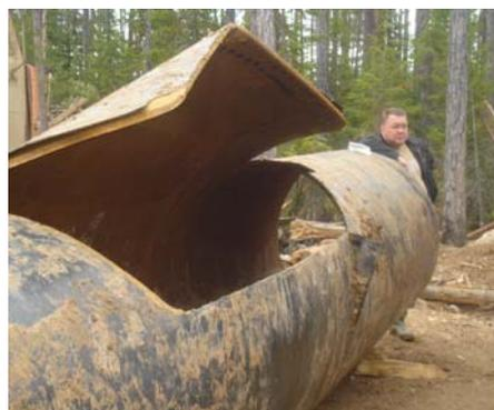
Рис. 6. Разрыв трубы после гидроиспытаний на трассе
