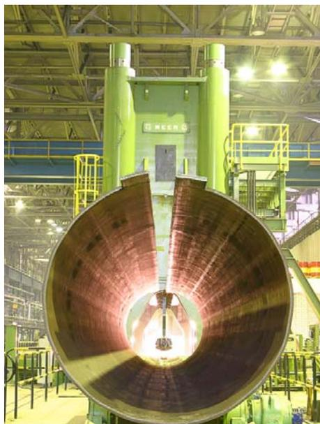
Рис. 3. Трубоформовочный пресс “SMS Meer”
