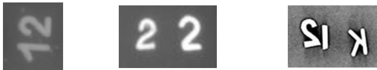
Рис. 2. Варианты внешнего вида маркировочных знаков на рентгеновских снимках
