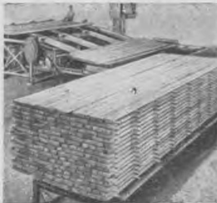
в первоначальное положение, а стол гидравлического подъемника автоматически выполняет свое перемещение на толщину ряда досок. Процесс повторяется до тех пор, пока не образуется полная пачка пиломатериалов.
