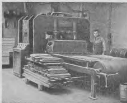
Рис. 6. Однопролетный фанеровальный пресс фирмы «С. Salvaneschi»
