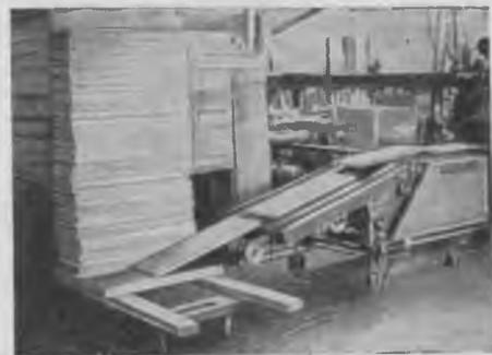
Укладчик работает автоматически независимо от толщины и формата щитов и скорости подачи станка. Скорость подачи транспортных ремней укладчика регулируется бесступенчато от 15 до 45 м/мин.
