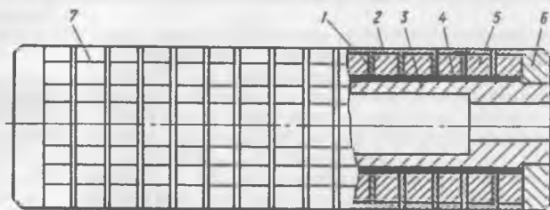
Рис. 2. Конструкция формного магнитного цилиндра:
