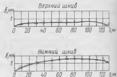
Рис. 1. Профилограмма износа ободов пильных шкивов станка модели ЛД-140 на Архангельском ЛДК № 1
