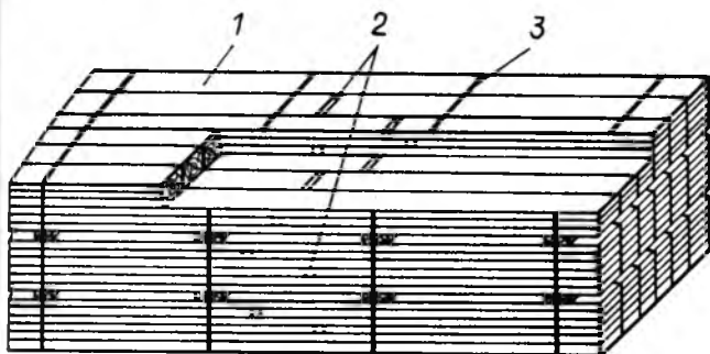
Рис. 1. Размещение в транспортном пакете пиломатериалов разных длин со стыкованием:
