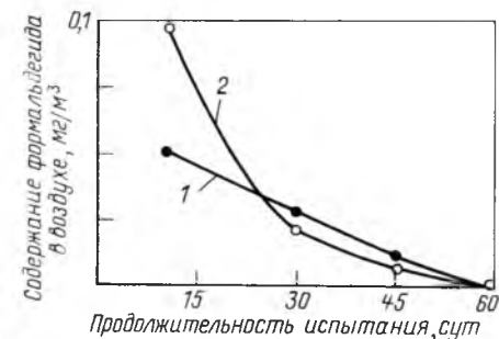
Рис. 2. Выделение формальдегида из фанеры ФК на смоле КФ-НФП: 1 — при 20 °С; 2 — при 40 °С
