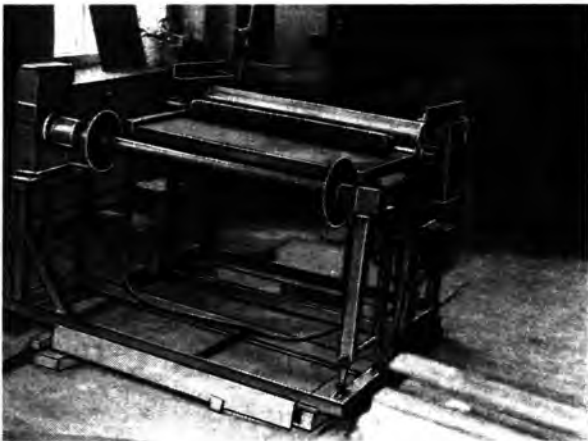
Рис. 1. Общий вид станка для обрезки шлифовальной шкурки
