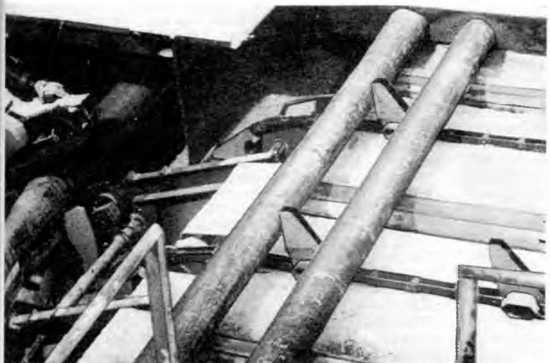
Рис. 3. Поперечный цепной конвейер, бревна с выравненными торцами комлей и бревно в калибровочном станке
