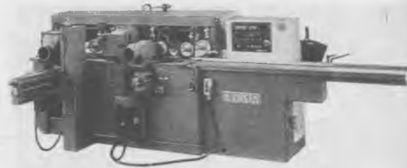
Рис. 5. Автоматический продольно-строгальный и профилирующий станок с 4—6 рабочими суппортами (максимальная рабочая ширина 220 мм, скорость подачи 5—26 м/мин)
