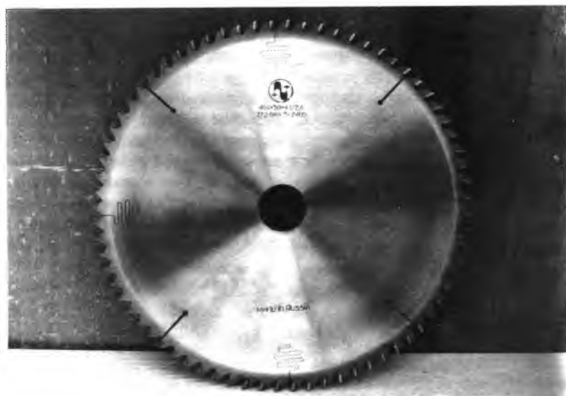
Рис. 2. Дисковая пила с термокомпенсационными пазами и вибропоглощающими прорезями
