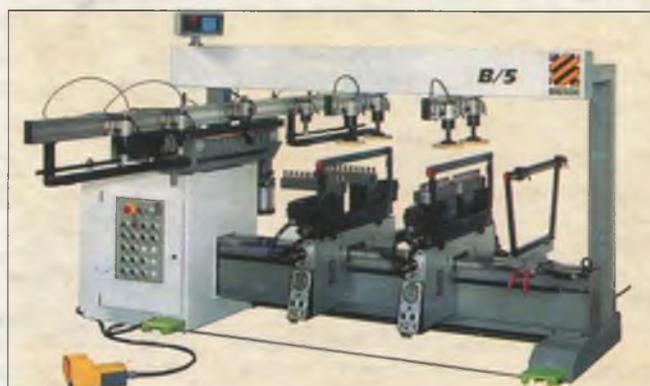
Станки присадочные и для установки шкантов – ручные, автоматические и с ЧПУ
