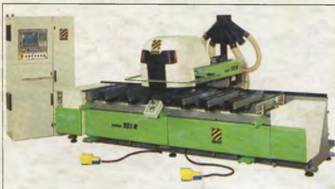
Универсальные центры с ЧПУ для сверления, фрезерования и шлифования деталей корпусной мебели, фасадов и дверей
