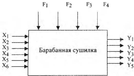
**Структурная схема процесса сушки древесных частиц в барабанной сушилке как объекта управления**
