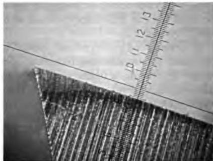
Рис. 3. Боковая поверхность вершины ПТС контрольного зуба основной пилы после заточки на предприятии
