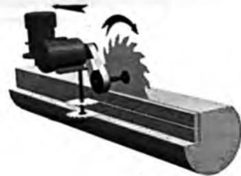
Рис. 8. Схема механизма резания станка "Гризли"
