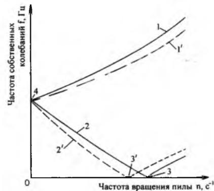
**Графики зависимости частоты собственных колебаний диска от частоты вращения пилы:**
