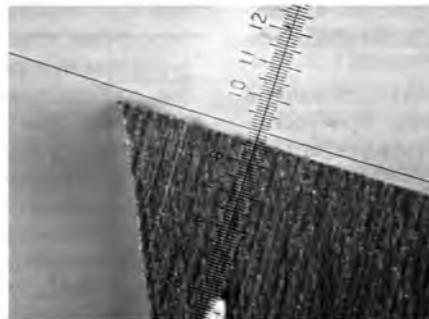
Рис. 2. Боковая поверхность вершины ПТС того же зуба основной пилы после заточки в лаборатории МГУЛа
