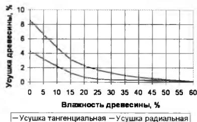
**Рис. 2. Графики зависимости тангенциальной и радиальной усушки древесины от её влажности**
