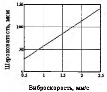
Рис. 2. График зависимости показателя шероховатости от виброскорости
