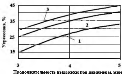
Рис. 2. Графики зависимости показателя упрековки внутренних слоёв от продолжительности выдержки под давлением – при различных величинах давления прессования: 1 – P = 2 МПа; 2 – P = 5 МПа; 3 – P = 8 МПа
