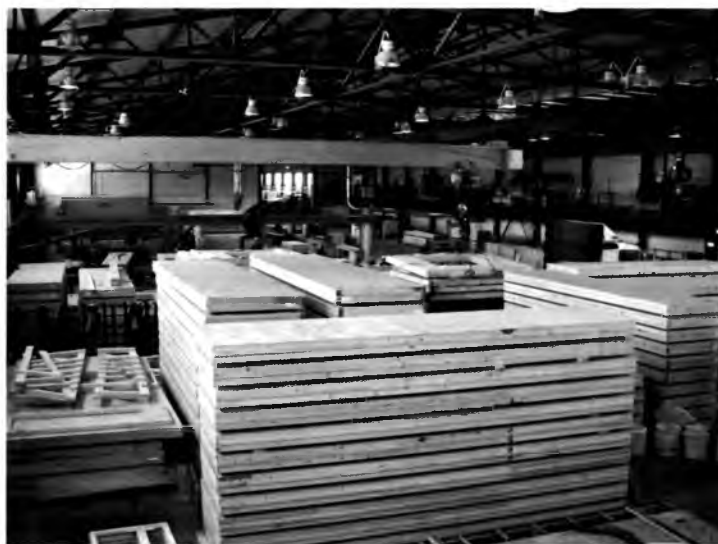
Рис. 1. Участок производства каркасных панелей
