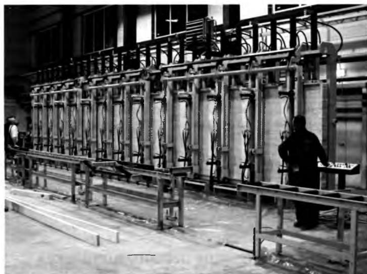
Рис. 3. Участок запрессовки клеёных деревянных конструкций
