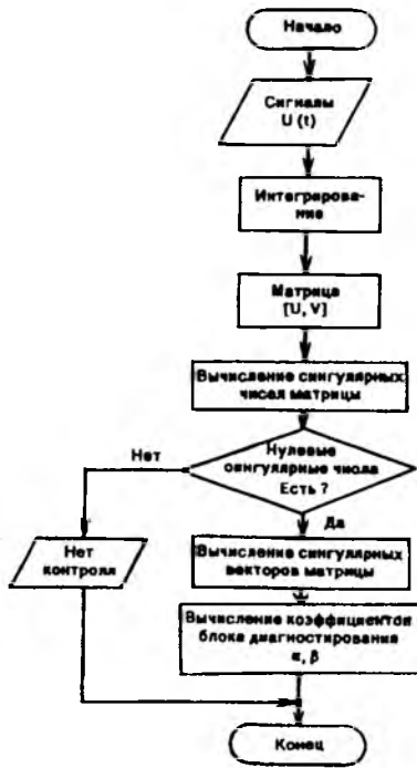
Рис. 3. Схема алгоритма идентификации параметров блока диагностирования
