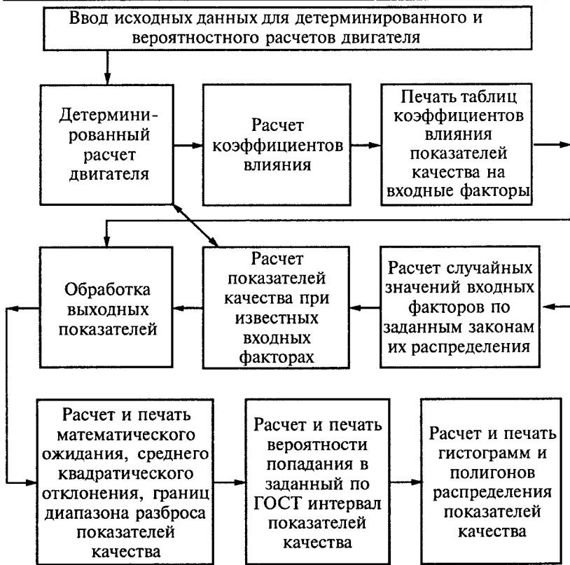
Рис.2. Схема алгоритма вероятностного расчета электромеханических характеристик двигателя
