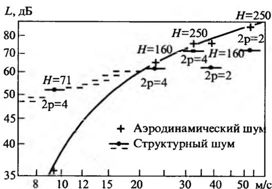
Зависимость аэродинамического и структурного шумов от линейной скорости лопаток рабочего колеса
